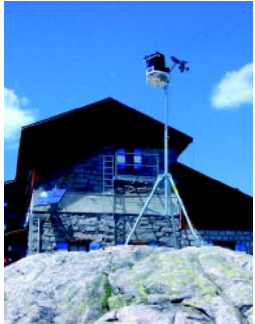
Una delle stazioni di rilevamento, posizionata da Meteotrentino al Rifugio Stavel "F. Denza"
